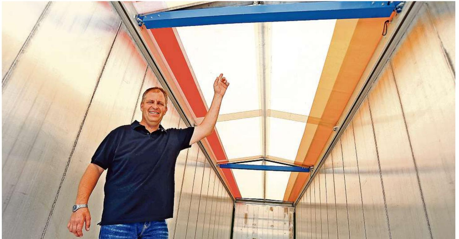
Marc Seewald traut seiner Erfindung einen Erfolg wie dem Sicherheitsgurt oder dem Airbag zu. Der „Anti Ice Lift“ hebt mechanisch die Aufliegerplane des Lkw-Anhängers nach oben.
